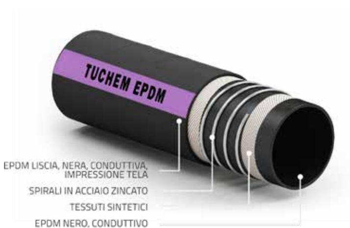
Tubo progettato secondo la norma EN 12115 per aspirazione e mandata di prodotti chimici. Tubo testato e certificato da BUREAU VERITAS per utilizzo in area Atex (Ex-Zone).
